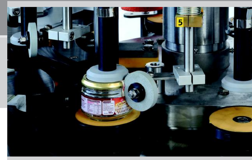
Sistema chiusura sigillo di garanzia adesivo su vasetto Secure roll-down of pressure sensitive tamper evident seal after application Système de fermeture de sigilles de garantie adhésifs sur récipient Sistema de precinto de garantía en autoadhesivo para el envase Versiegelungsvorrichtung durch selbstklebenden Garantie-Streifen auf Gefäße
